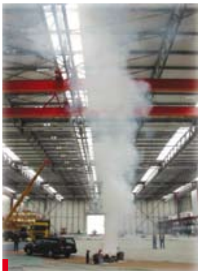
Fot. 1. Próby z ciepłym dymem w hali magazynowej [3]
