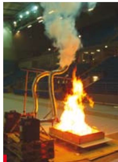
Fot. 3. Stanowisko do przeprowadzania prób z gorącym dymem w trakcie badania [3]
